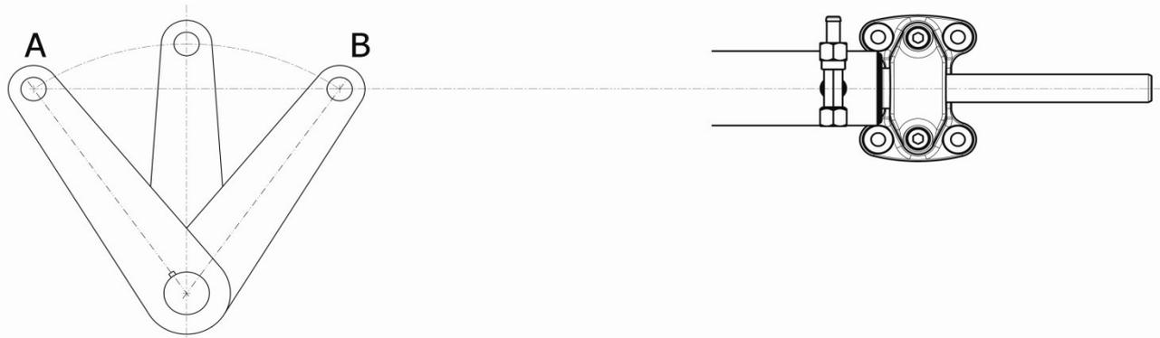
Le lettere A e B rappresentano i punti di fine corsa della barra del timone. Allineare l'ipotetica retta passante per i punti A e B con l'asse del cilindro.
