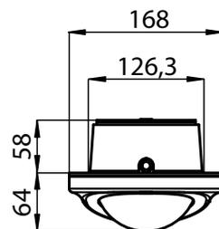
Bussola magnetica installazione ad incasso a soffitto
