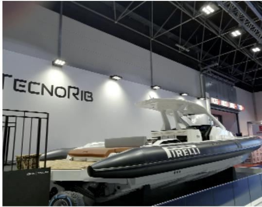
13,10 metri di lunghezza, 4,1 metri di larghezza, un walk around dalle linee aggressive con dettagli di charme che può montare sia motori fuoribordo che entro bordo, diesel e benzina, con una potenza massima prevista di 900 cavalli.
